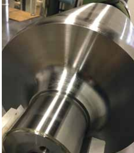
Walze, Grundkörper aus Stahl, chromiert
